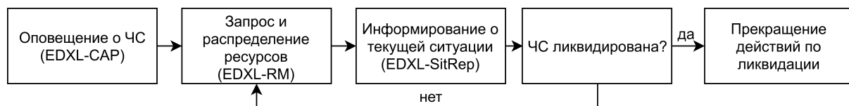
Рис. 9. Охват жизненного цикла ЧС с помощью программной реализации стандартов EDXL (в скобках указаны используемые стандарты сообщений)
